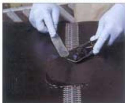
Le resine poliuretanicche FLEXANE liquide sono facilmente colabili e sono suggerite come rivestimento antiabrasione e strappo su sistemi di trasporto a nastro e pneumatici. Esistono diverse durezza: Flexane 94 - veloce indurimento, relativamente rigido Flexane 80 - maggiore tempo aperto, maggiore flessibilità Flexane 60 - tempo aperto molto lungo, estremamente flessibile
