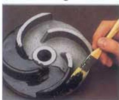
Rivestimento poliuretanicco pennellabile di alte prestazioni. Protegge contro l'impatto, l'abrasione, l'urto, l'usura e la corrosione. Indurisce in una gamma di media durezza con eccellente flessibilità, ottima resistenza a trazione e allo strappo. Può essere applicato a pennello con uno spessore di 1,3 mm con una mano. Forma uno strato protettivo e insonorizzante.
