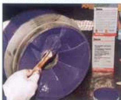
Composto ceramico a bassa viscosità, applicabile a pennello per la protezione contro la corrosione galvanica, la vaiolatura (pitting) l'erosione e la cavitazione fino a 180°C. Permette la ricostruzione molto precisa di zone usurate di profondità fino a 3 mm. Può essere usato in presenza di acqua potabile.
