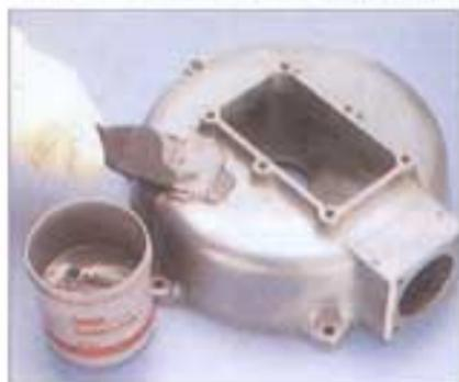
Composto epossidico caricato alluminio per riparazioni lavorabili e anticorrosive di fusioni in alluminio, parti di macchine e impianti. Aderisce ad altri metalli e alle plastiche. Termoindurente. Eccellente resistenza ai solventi e agenti chimici. Indurisce completamente in 12 ore a temperatura ambiente.
