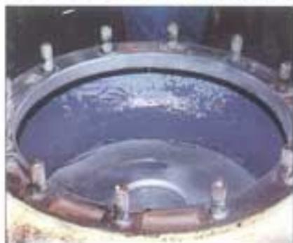
Composto epossidico caricato con ceramica per riparazioni anticorrosione con finitura liscia e per ricostruzioni di superfici di metalli diversi o a basso attrito come guide e flange. Protegge contro l'abrasione severa, l'erosione e la corrosione bimetallica. Aderisce alla maggior parte dei metalli, al cemento e ad alcune plastiche.
