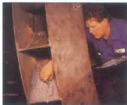
Evita l'abrasione e l'usura causata da particelle di diametro pari a 3,2 mm o superiore. Garantisce la massima protezione alle superfici metalliche, ceramiche e di cemento usate per il trasporto di solidi. Aderisce permanentemente a superfici verticali o sospese.
