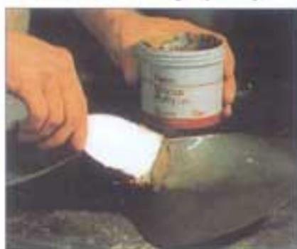
Composto epossidico caricato bronzo per la ricostruzione e il mantenimento di fusioni in bronzo e ottone, bronzine, alberi ed altri componenti dove la brasatura è impossibile. Aderisce in modo tenace al bronzo, all'ottone, ai metalli ferrosi e al cemento. Facile da lavorare a macchina, forare e maschiare.
