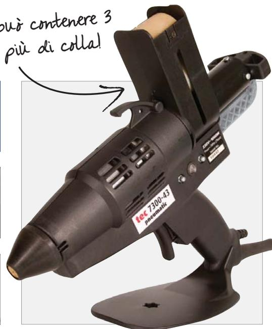
Pistola a colla a spruzzo per uso industriale da 43mm (1 3/4") estremamente robusta. Spruzza un getto di colla in misura maggiore o minore a seconda della regolazione scelta e ugello. Può coprire vaste aree con uno spruzzo adesivo atossico. Applica colla su materiali sensibili al calore senza danni. Necessita di aria compressa di 8 bar (120psi) 85 l/min (3 cfm).
